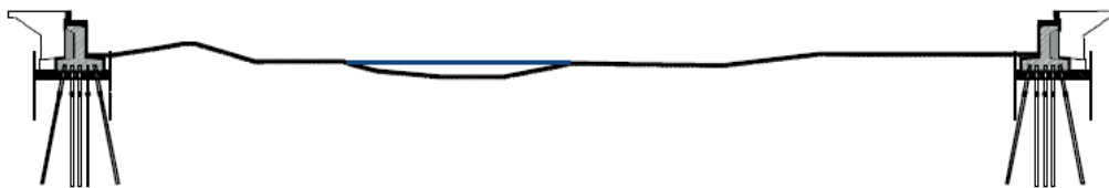
Rysunek 2 Wykonanie podpór skrajnych posadowionych na palach prefabrykowanych
